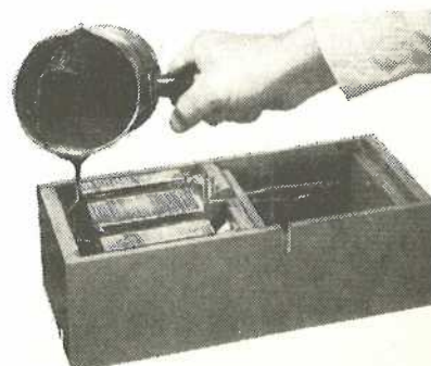
Fig. 3. De kern met spoel wordt met was of paraffine overgoten.
